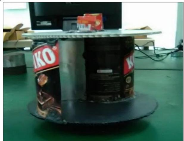
Fig. 1. Savonius Wind Turbine
